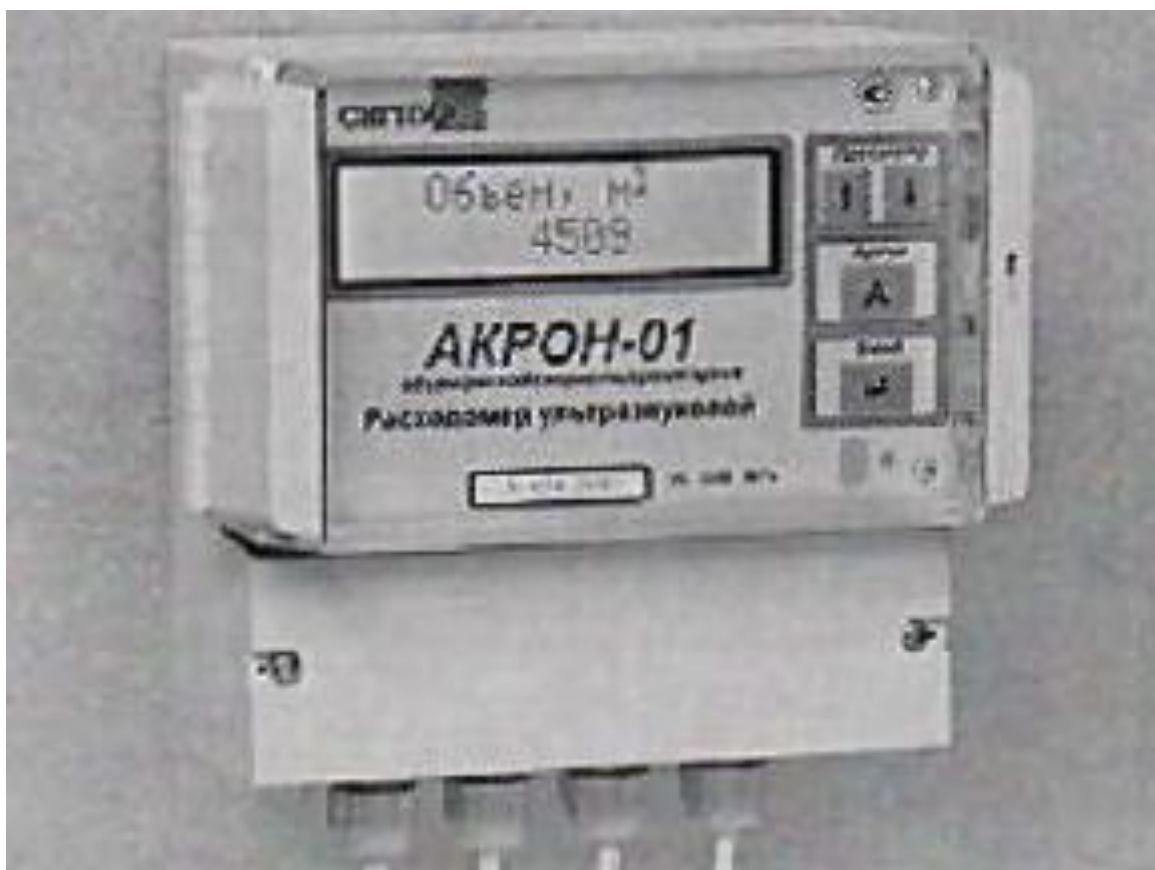
Рисунок 12 – Расходомер учета подпиточной воды «Акрон-1»
