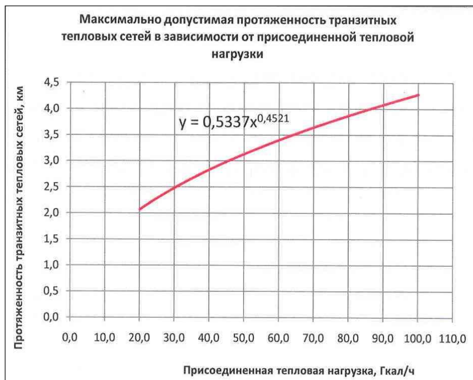
Рисунок 21 - Максимально допустимая протяженность тепловых сетей в зависимости от присоединенной тепловой нагрузки от 20 Гкал/ч
